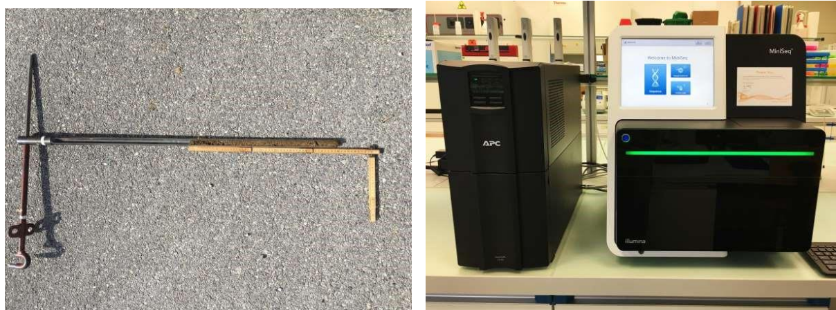
Figure 38. Tarière d'échantillonnage (gauche) et le séquenceur Illumina MiniSeq du laboratoire (droite)
