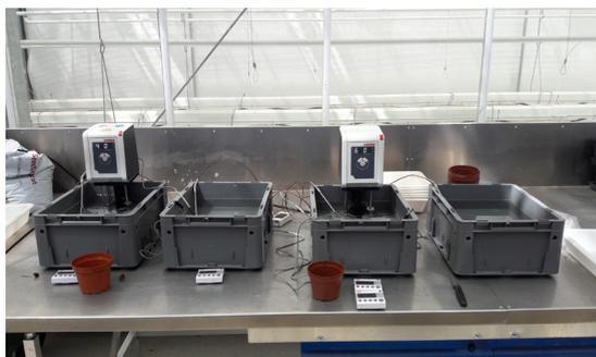
◀ Dispositif utilisé lors des différents essais pour le traitement thermique des rhizomes de renouée
