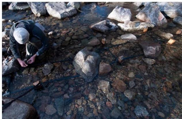
Figure 4 : Photos d’installation d’antennes « pass-over »
