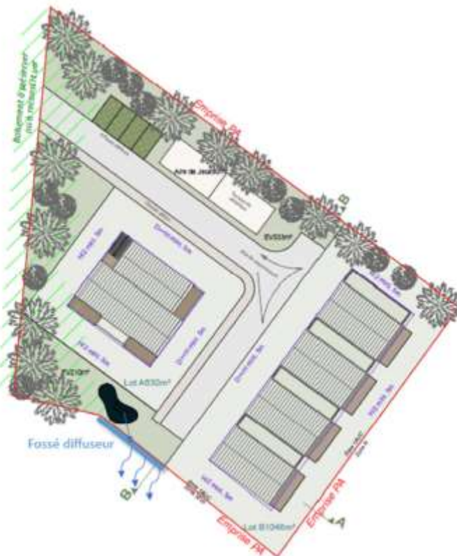
Figure 4 : Mesure d'accompagnement : création d'un fossé diffuseur dirigeant les eaux pluviales issues du bassin de rétention vers la zone humide
